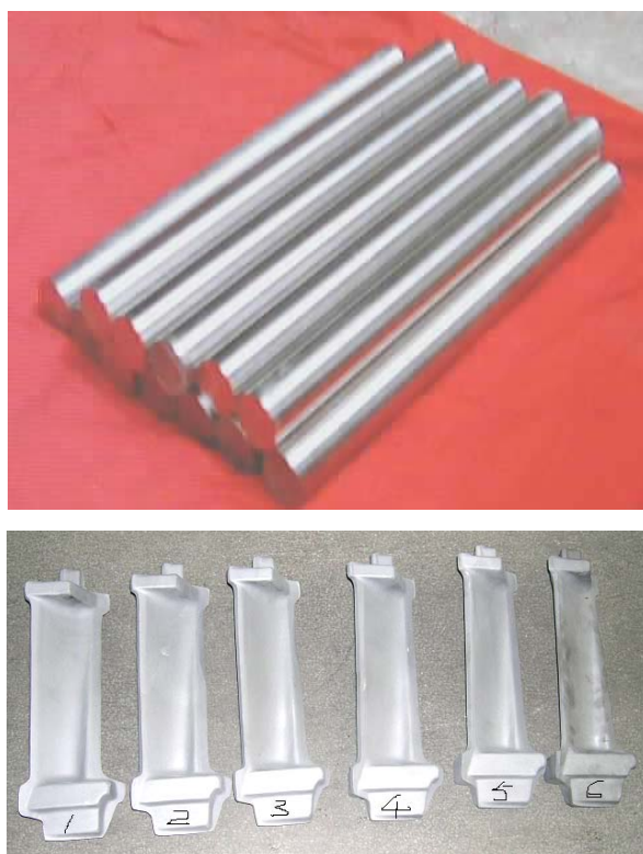
图3 GH4413热轧棒材及模锻叶片毛坯件
