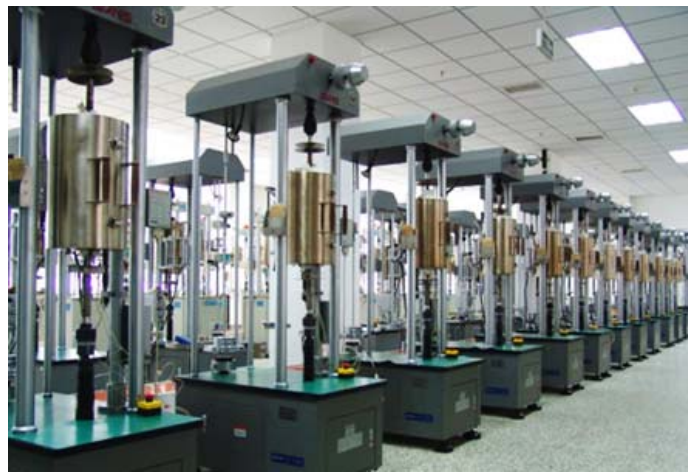
图1 中科院金属所的高温合金材料制备设备及持久蠕变试验机
