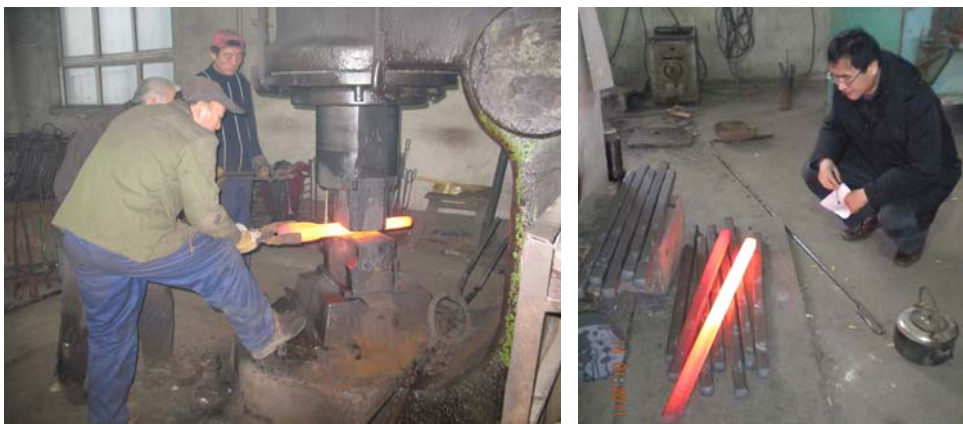
图2 实验室规模的GH984G合金锭的开坯锻造
